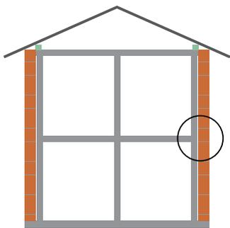
**ненесущие** – воспринимающие нагрузку только от собственного веса и ветра в пределах одного этажа при высоте этажа не более 6 м, при большей высоте этажа эти стены относятся к самонесущим;
