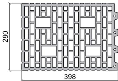
Завершение рядов кладки в углах, оконных, дверных проемах и при пересечении стен
