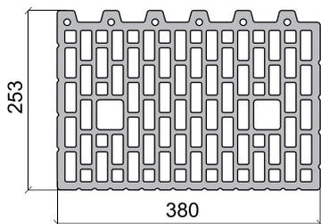
Завершени рядов кладки в углах, оконных, дверных проемах и при пересечении стен
