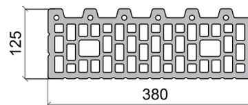
Завершение рядов кладки в оконных, дверных проемах и при пересечении стен, для обеспечения перевязки в половину камня
