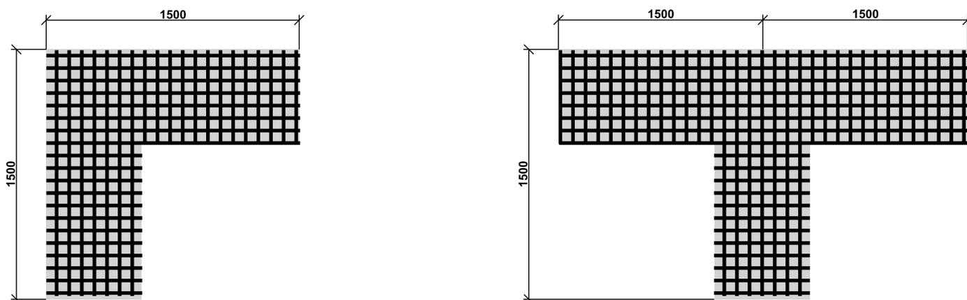
При перевязке основного слоя из камня POROMAX с лицевым кирпичным слоем при помощи базальтовых арматурных сеток, дополнительное армирование кладки не требуется, при соединении слоев одиночными гибкими связями, а также при однослойной кладке, требуется выполнение конструктивного армирования кладки, как указано выше.
