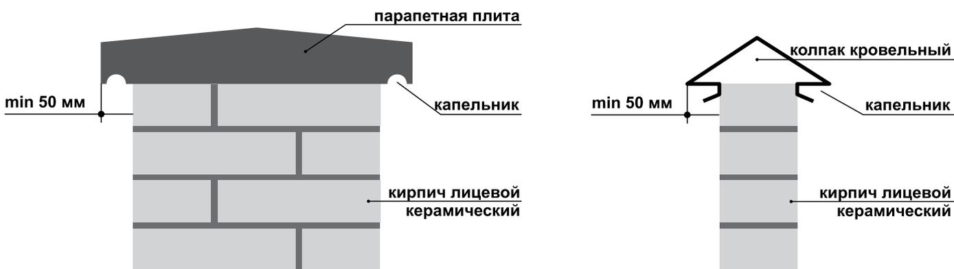
Кровельная водосточная система должна быть правильно смонтирована и исключать проникновение атмосферной влаги в стены. Особое внимание необходимо уделять защите от тающего снега и внутренним углам здания.
