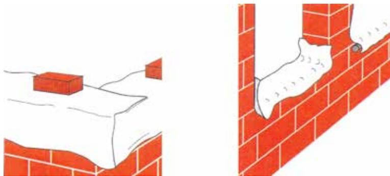
Парапеты, подоконники, пояски, открытые простенки и столбы, обрез кирпичного цоколя и прочие выступающие части стен должны быть надежно защищены от увлажнения морозостойкими плитами с капельниками или колпаками из кровельной стали (меди). Вылет плит и колпаков за плоскость стены должен составлять не менее – **50 мм**, капельники обязательны.
