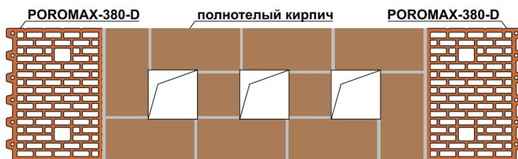
**Вентиляционные каналы** в стенах из камня POROMAX следует выполнять устройством специальных труб в теле кладки или устройством участка стены из полнотелого керамического кирпича марки не ниже М100.
