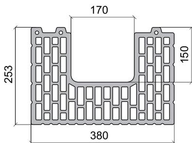
Устройство вертикальных железобетонных сердечников в стенах комплексной конструкции в углах и при пересечении стен
