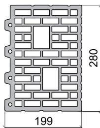
Завершение рядов кладки в оконных, дверных проемах и при пересечении стен, для обеспечения перевязки в половину камня
