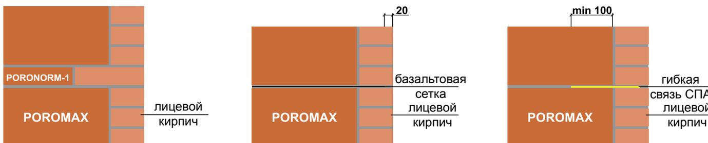
Глубина заделки одиночных связей в растворный шов должна составлять не менее **100 мм** в основном слое из камня POROMAX, в облицовочном слое из кирпича 1NF – **90 мм**, 0,7NF – **60 мм**. Связи должны отстоять от вертикальных растворных швов не менее чем на **20 мм**.
