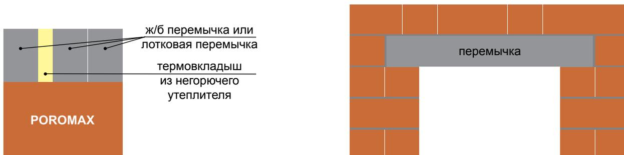
Лотковые и монолитные железобетонные перекрычки, должны выдерживаться в опалубке при температуре наружного воздуха: до **5°C** не менее **24 суток**, до **10°C** не менее **18 суток**, до **15°C** не менее **12 суток**, до **20°C** не менее **8 суток**, свыше **20°C** не менее **5 суток**.
