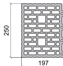
Завершение рядов кладки в оконных, дверных проемах и при пересечении стен, для обеспечения перевязки в половину камня
