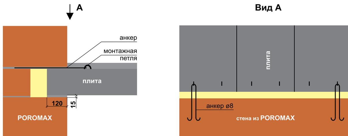
В сейсмических районах перекрытия следует выполнять как жесткие горизонтальные диски, надежно соединенными с вертикальными конструкциями здания, опирание сборных плит перекрытия на кирпичные и каменные стены должно быть не менее **120 мм**.
